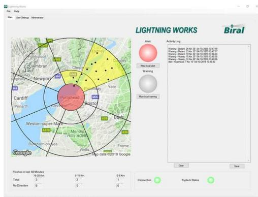
Avec le module externe optionnel Direction Finder, la direction de la zone d'impact de tous les éclairs est détectés. Ces informations sont automatiquement tracées sur la vue de la carte dans l'application logicielle Lightning Works, indiquant la portée et la direction.
