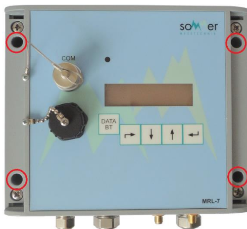
Figure 4 Trous de fixation de MRL-7
