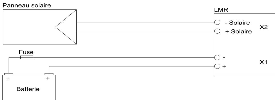
Figure 5 Câblage d'un panneau solaire
