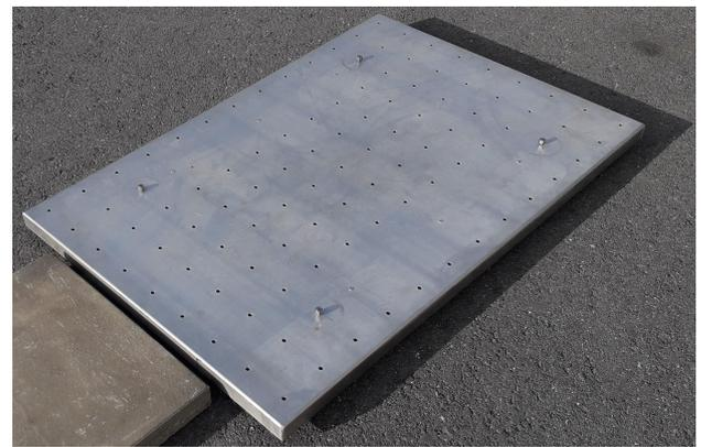
Die SSG-2 Small Schneewaage ist ein Präzisionsgerät zur Messung des Schneewasseräquivalents (SWE) einer Schneeschicht. Sie wurde für die einfache Installation auf Dächern entwickelt und ist mit einer leichten Aluminiumplatte ausgestattet, die den Wärmewiderstand reduziert, wodurch der Wärmefluss durch das Gerät verbessert wird. Die SSG-2 Small ist mit analogen und digitalen Anschlüssen ausgestattet, die die Integration in Wetterstationen und andere Überwachungssysteme ermöglichen.
